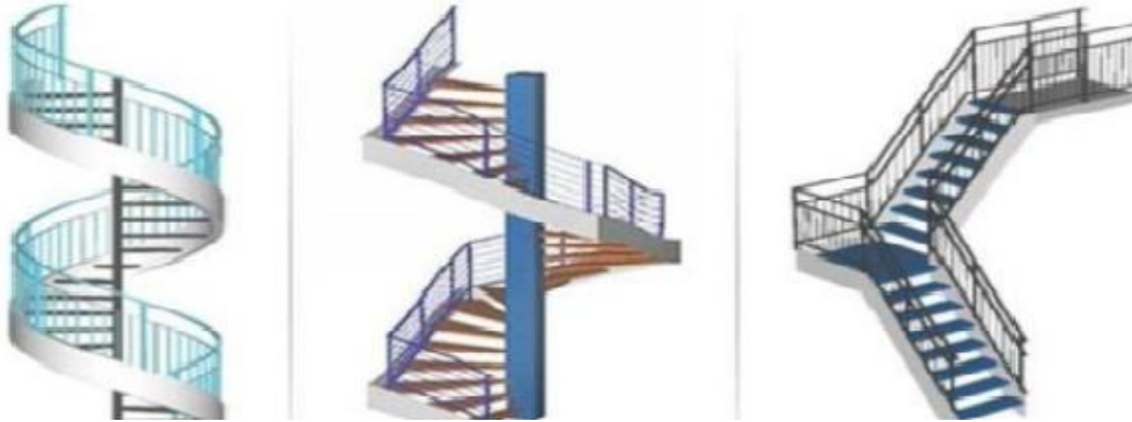
Figure I. 6: Escaliers en charpente métallique.
