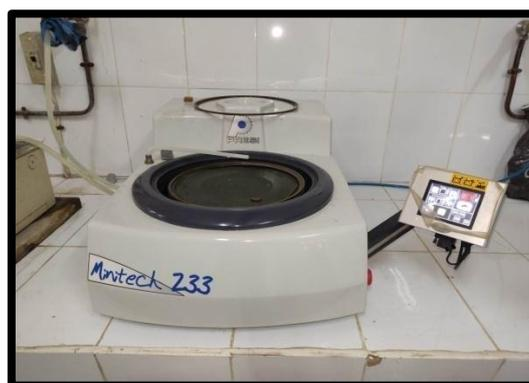
Figure IV. 9 Polisseuse mécanique.
