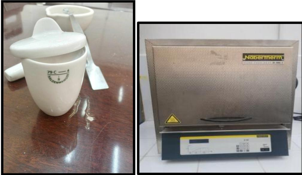
Figure IV. 7 Creuset en Alumine. Figure IV. 8 Four (Nabertherm B180).
