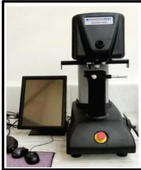
**FigureIV. 27 Micro d'uromètre de type Vickers (INOVATEST FALCON 400)**
