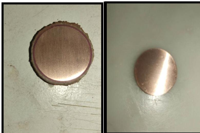
**Figure IV. 11 Pastille avant et pendant et après polissage.**
