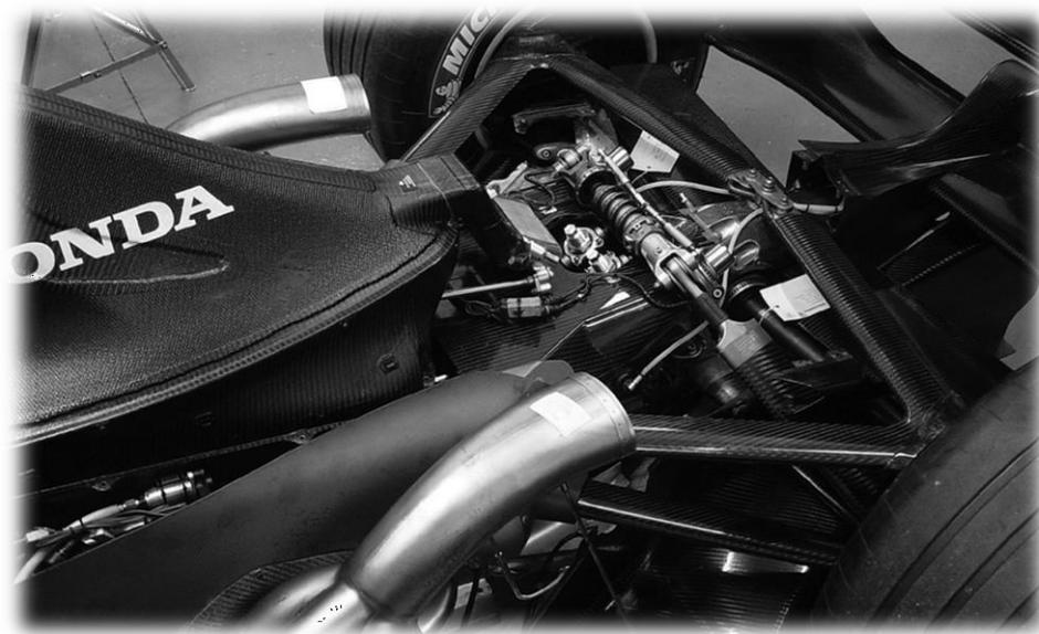
**Figure I- 20 : Suspension et boîte de vitesses en époxy renforcé de fibres de carbone dans une voiture de course de Formule 1.[14]**
