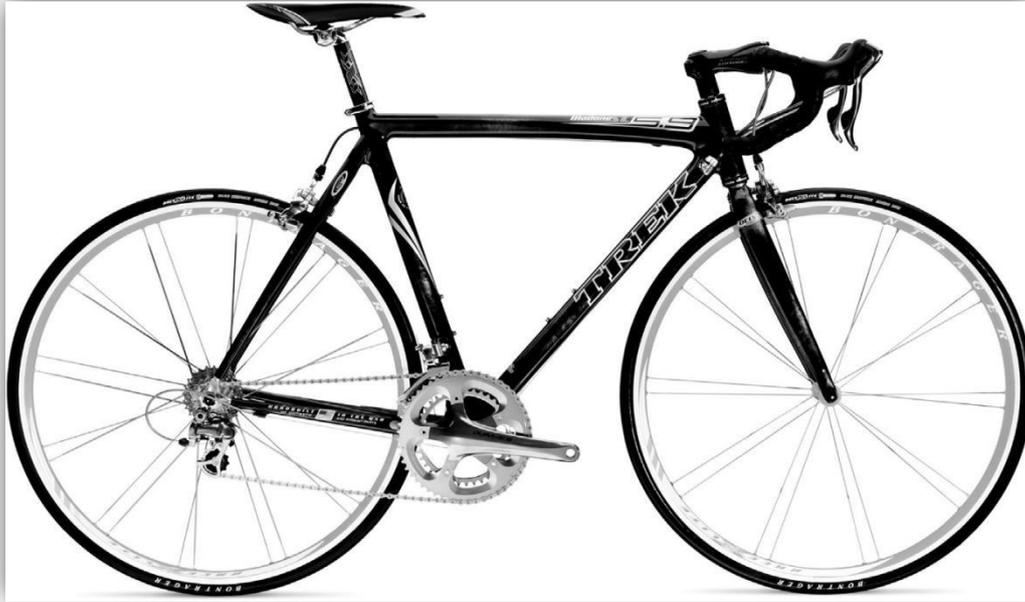
**Figure I- 21 : Cadre de vélo en époxy renforcé de fibres de carbone. [16]**
