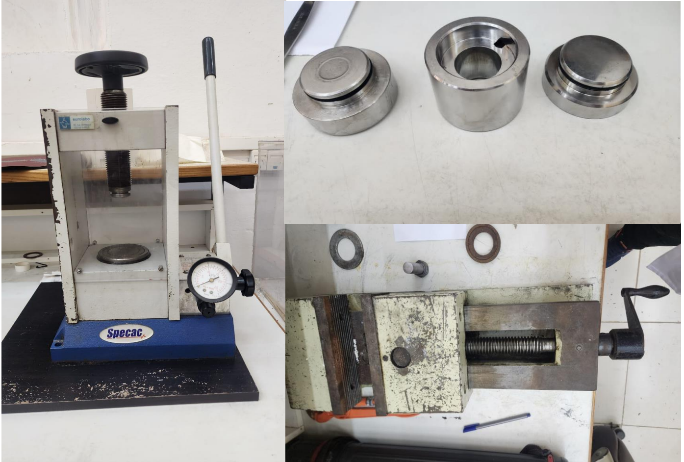
Figure 30 : la presse hydraulique et le dispositif de compactageutilisé.
