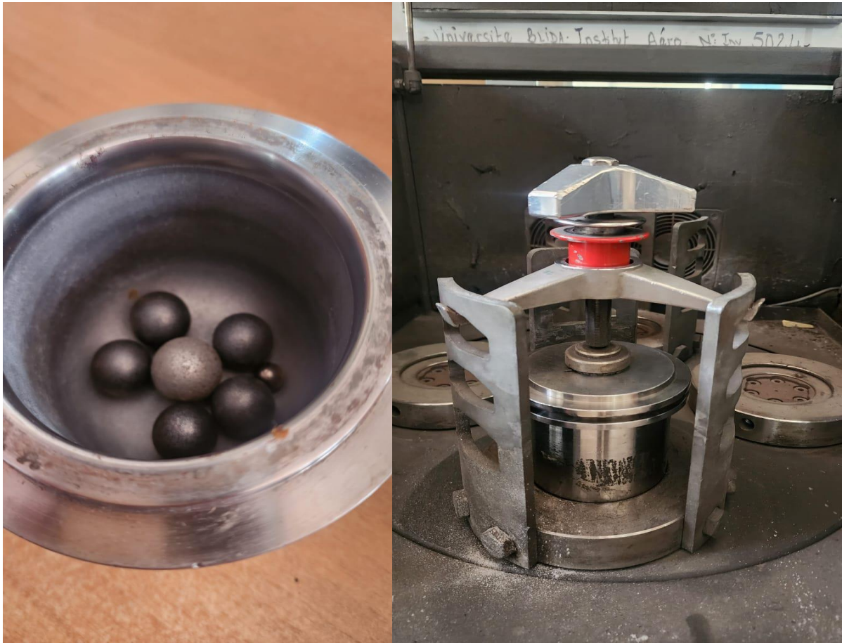
Figure 28 : la jarre avec les billes et la fixation de la jarre dans le broyeur.
