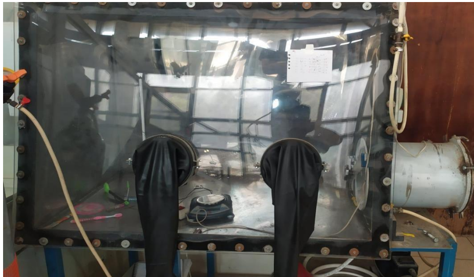
Figure 29 : boîte à gants sous atmosphère d'argon.
