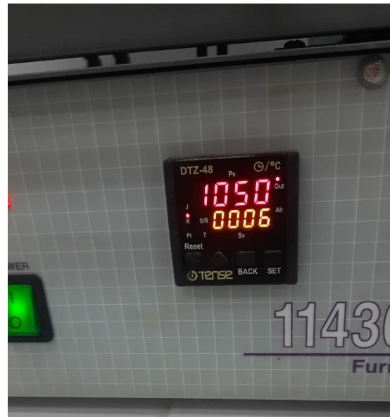
Figure 34 : Le frittage en début de degré 1050°C.
