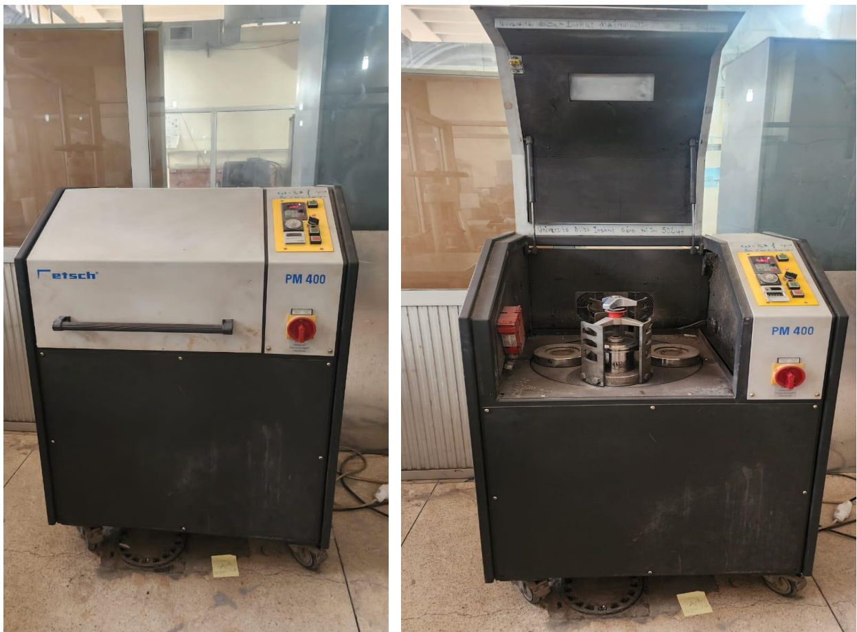
Figure 26 : Le broyeur planétaire de haute énergie "retsch PM 400".
