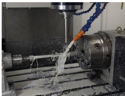
Figure I. 14: Usinage 4 axes de surface gauche
