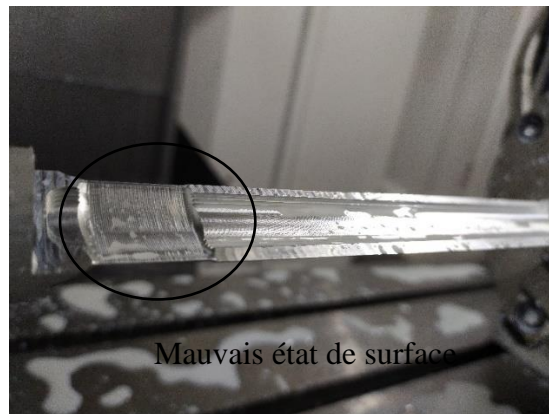
Figure III. 52: Mauvais état de surface
