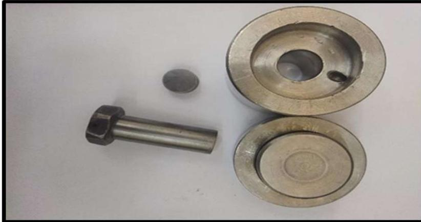
Figure III.7 : Dispositif de compactage de diamètre 18 mm
