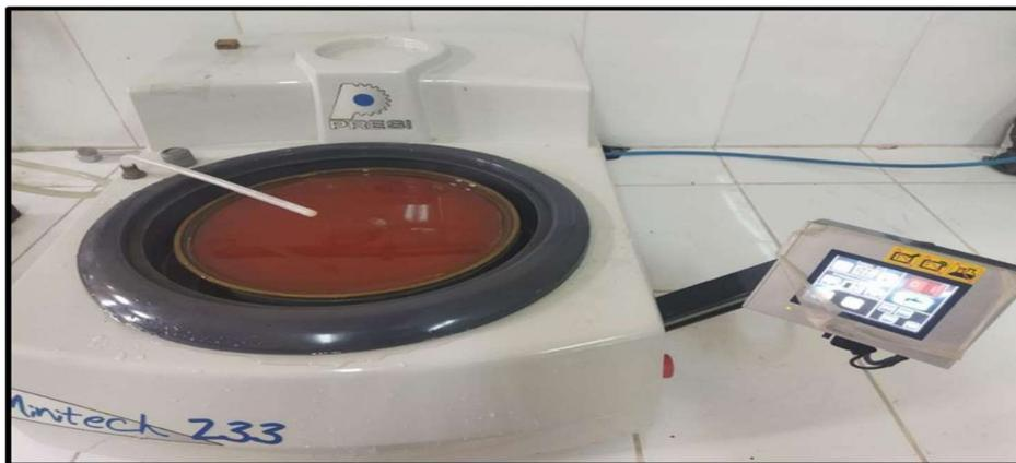
**Figure III.12 :** polisseuse mécanique
