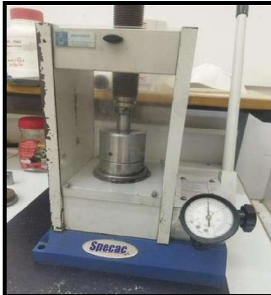
Figure III.8 : Une presse hydraulique de type SPECAC
