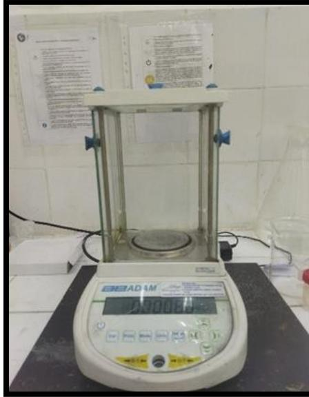
**Figure III.5** : Balance de précision  $10^{-4}$  g.
