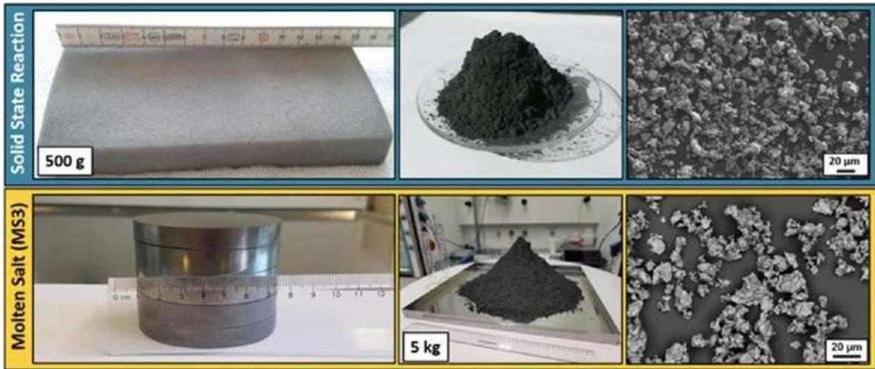
**Figure I.8:** Photographies et images MEB de la réaction et synthèse à l'état solide pour 500g de  $\text{Cr}_2\text{AlC}$  protégé de sel fondu [18].
