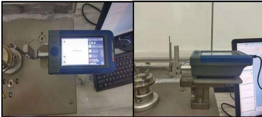
**Figure III.16** : profilomètre 2D
