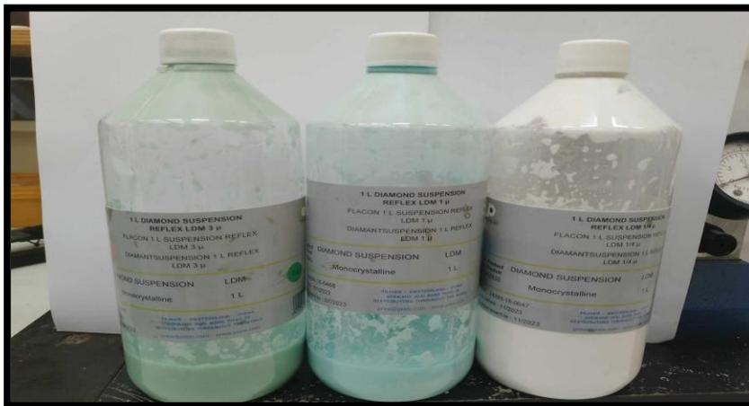
Figure III.14 : Solutions diamantées 3 $\mu$ m, 1 $\mu$ m et 0,25 $\mu$ m
