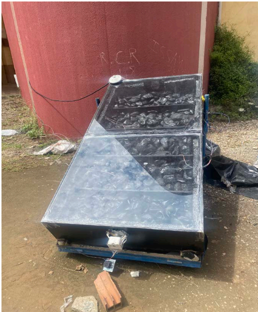
Figure (II-7) : photo représente le capteur solaire réalisé fini
