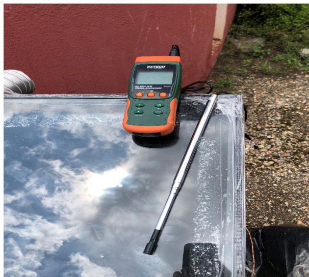
Figure (III-6) : photo de l'anémomètre
