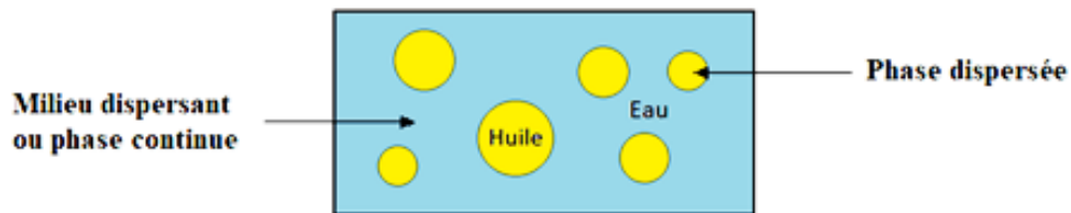
Figure II.5 : Schéma descriptif d'une émulsion (H/E) [54].
