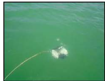
Fig. 27: Mesure de la transparence dans le barrage de Ghrib au mois d'Avril
