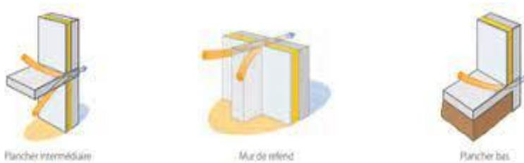
**Figure 1.17 :** *les ponts thermiques de liaisons structurelles*
