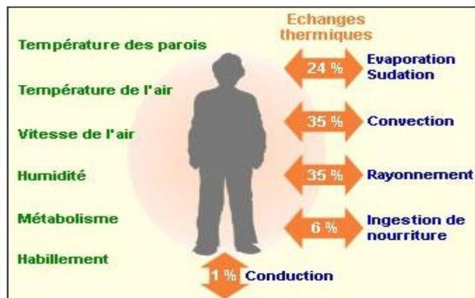
Figure 1.8 : les pertes thermiques du corps
