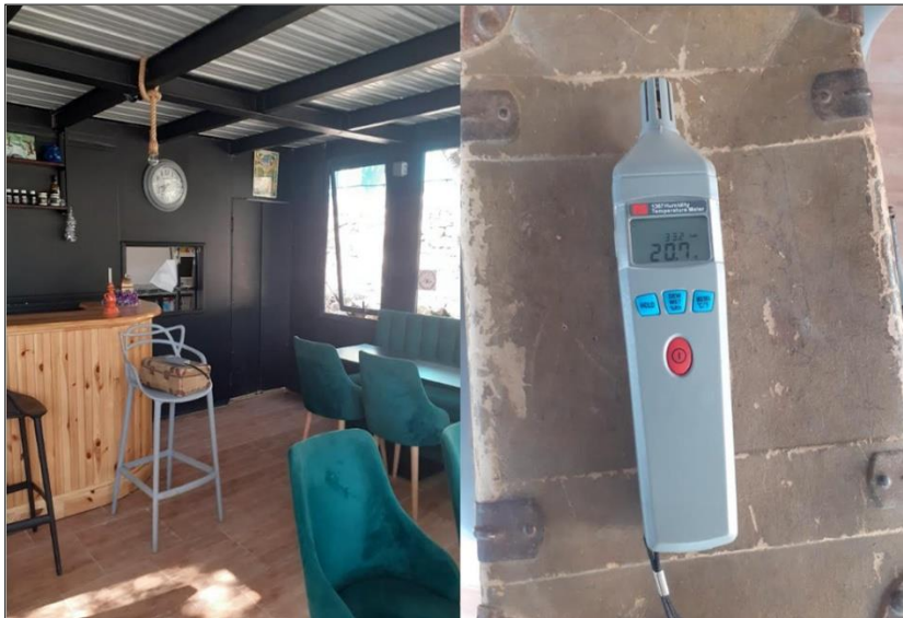
Figure 2.15 : méthode de mesure avec TESTEUR HUMIDITE ISOTECH RS-1367 Source auteur le 10/01/2023
