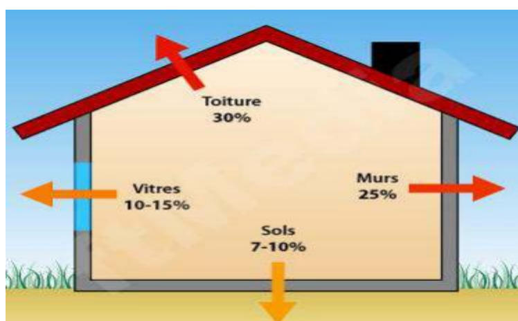
Figure 1.15 : déperditions thermiques dans le bâtiments[20]
