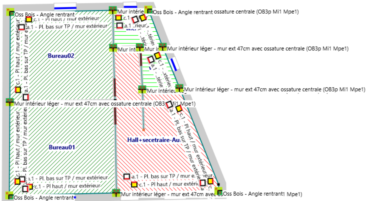
Figure III.33 : Les ponts thermiques
