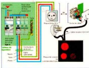
Les schémas pratiques illustrent en couleurs le cheminement des conducteurs du tableau de protection jusqu'aux appareillages et aux points d'utilisation. Il vous suffit de suivre les fils !
