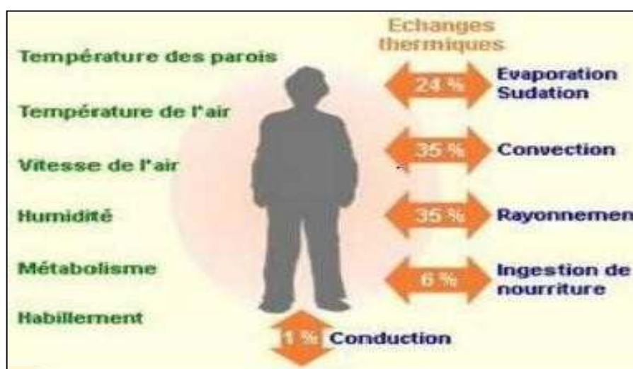
Figure I-7 : Les paramètres du confort thermique
