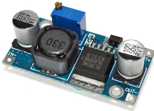
Figure III.13 : convertisseur élévateur dc-dc xl6009 4a [25]
