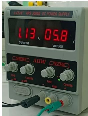
**Figure III.14 :** photo d'alimentation stabilisée de test Peltier avec un  $V_{max}$  et  $I_{max}$
