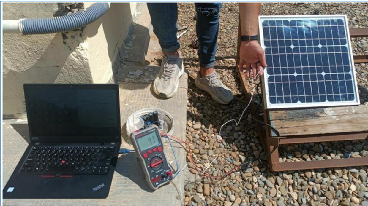
**Figure IV.4 :** Banc de caractérisation du module PV par le traceur [26]
