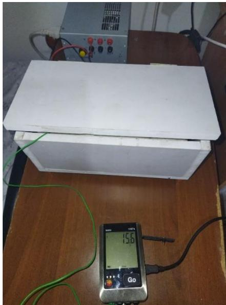
**Figure IV.1** : étalonnage du thermostat utilisé par Testo 176T
