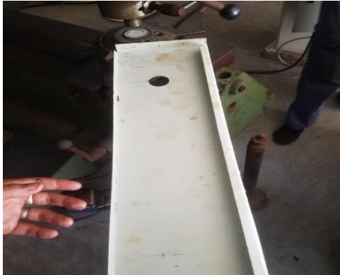
Figure 3. 14 : Les parties du caisson après le pliage
