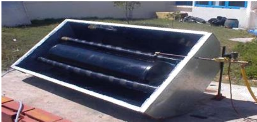
Figure 1.15 Vue du capteur-stockeur à réflecteur cylindre-parabolique réalisé en Tunisie [14].
