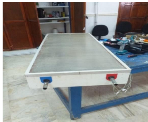
Figure 3. 25 : Pose de la vitre en polycarbonate et du cadre en aluminium
