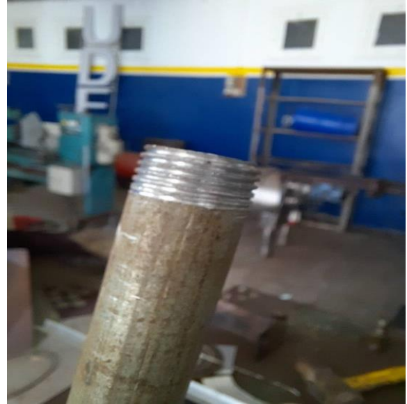
Figure 3. 18 Filetage réalisé sur les tubes d'entrée et sortie
