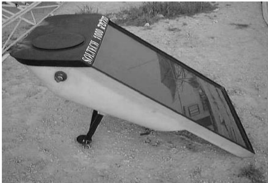
Figure 1.12 Photo montrant le prototype du capteur-stockeur amélioré par Faiman, [10]
