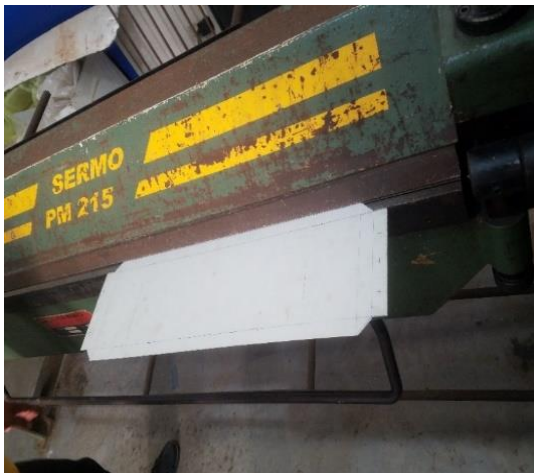
Figure 3. 11 Opération de pliage réalisée avec une plieuse manuelle
