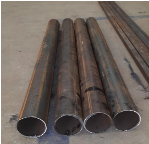
Figure 3. 17 Photos des tubes en acier utilisés pour le capteur-stockeur
