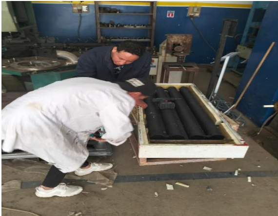
Figure 3. 24 Montage du capteur-stockeur à l'intérieur du caisson
