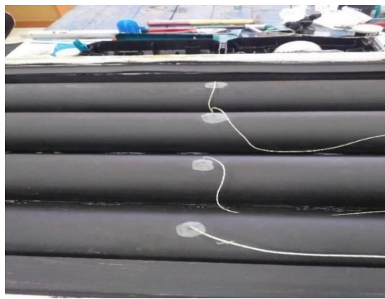
Figure 3. 29 emplacement des thermocouples dans les tubes
