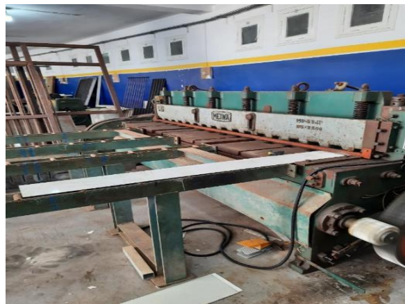
Figure 3. 12 découpage de la tôle avec une cisaille de guillotine
