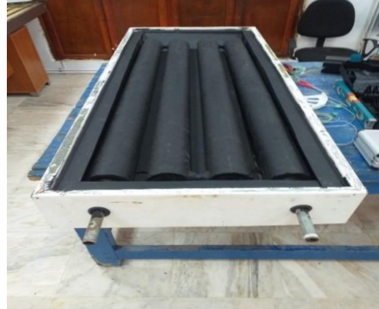
Figure 3. 24 Montage du capteur-stockeur à l'intérieur du caisson
