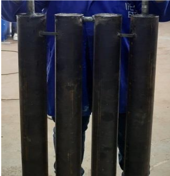
Figure 3. 19 : Soudage de tous les éléments du capteur-stockeur
