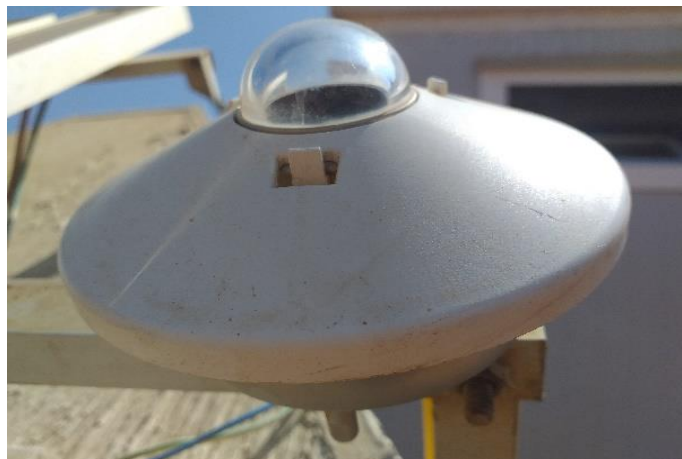
Figure 3. 30 La position du pyranomètre dans le système expérimental
