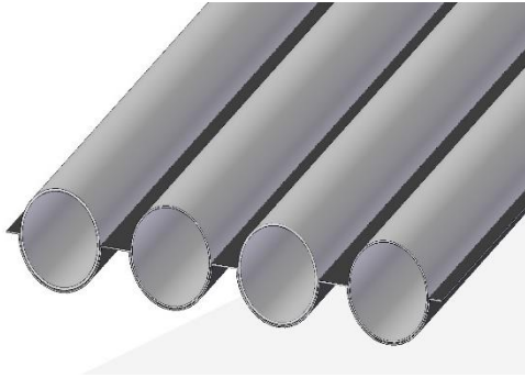
Figure 3. 3 élément absorbeur intègre avec capteur-stockeur réalisée sur Solid Edge
