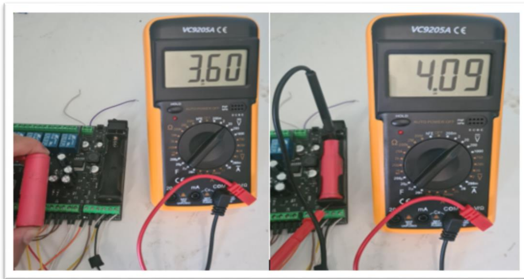
Figure IV-6 L'indication du charge du batterie du dispositif
