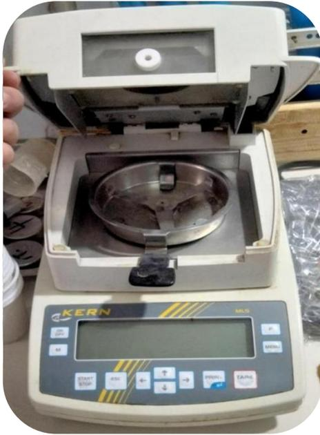
**Figure N°(11) : Appareil d'extraction à sec**
