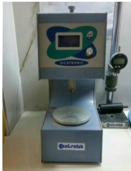
**Figure N°(15) : Prisomètre automatique**
