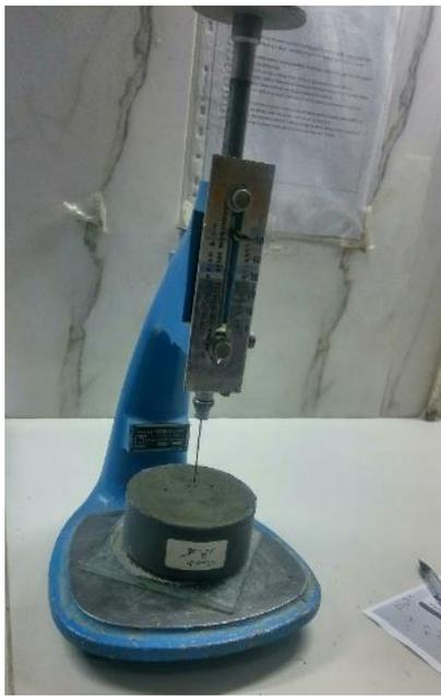
**Figure N°(14) : Prisomètre manuel**
