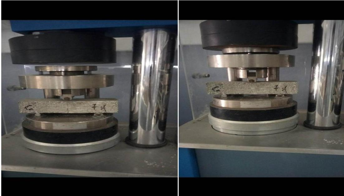
**Figure N°(07) : Mortier soumis à la flexion 3 points**
