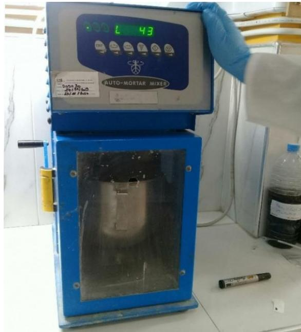
**Figure N°(13) : Malaxeur automatique de béton**
