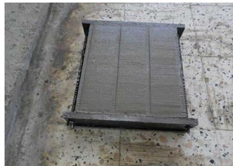
**Figure N°(04) : Mortier après arasement**
