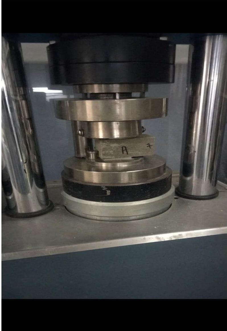
**Figure N°(09) : Mortier soumis à la compression pure**
