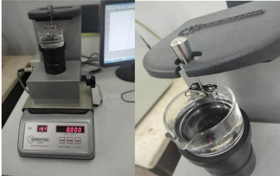
**Figure N°(17) : Tensiomètre interfaciale digital a force**
