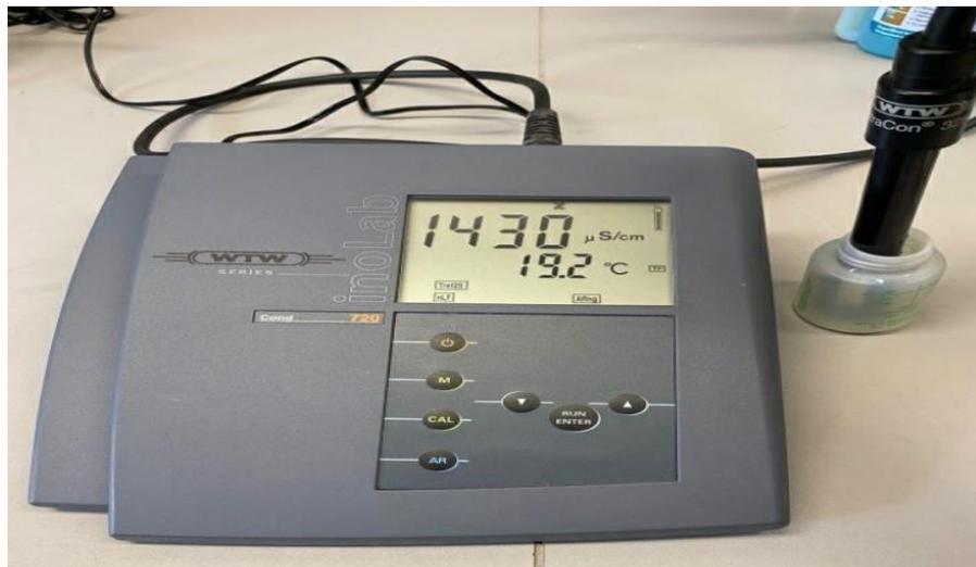
**Figure N°(18) : Conductimètre**
