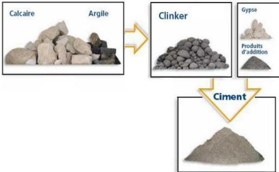
**Figure N°(02) : Fabrication du ciment**
