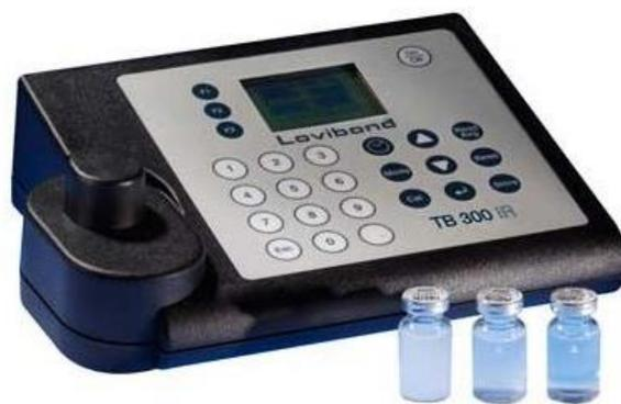
**Figure N°(19) : turbidimètre**
