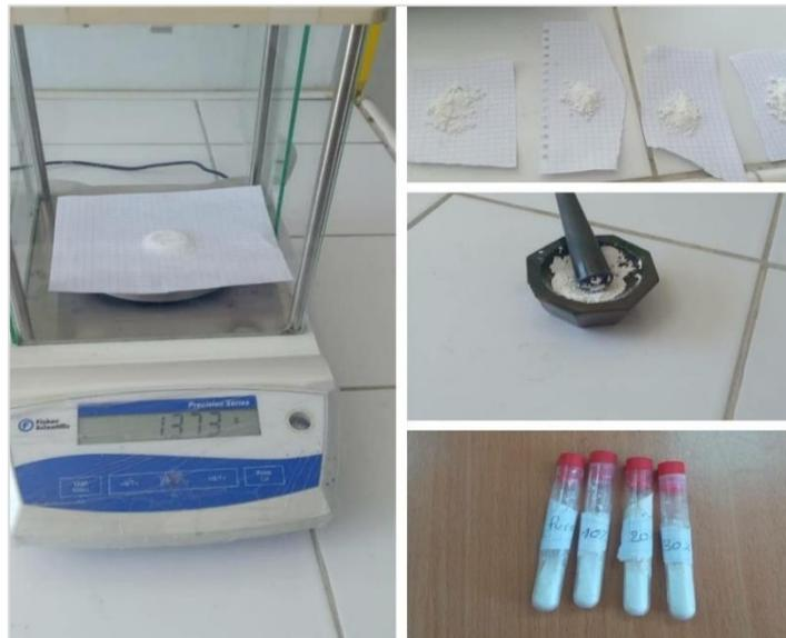
Figure III.7 : Les étapes de préparation du  $\text{TiO}_2$  dopé avec  $\text{Al}_2\text{O}_3$
