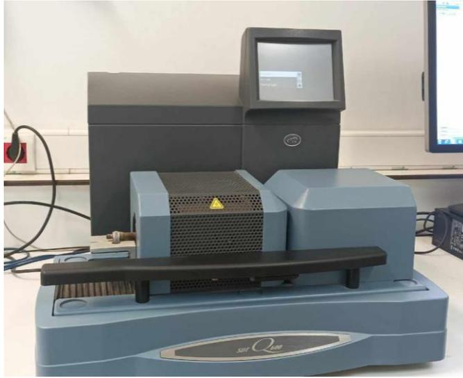
Figure II.27 : Appareille de ATG et ATD
