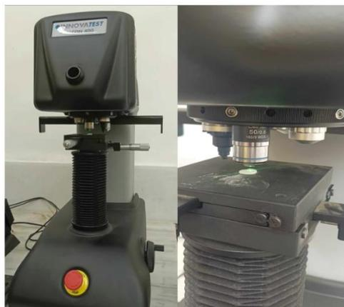
Figure II.30 : Micro-duromètre.
