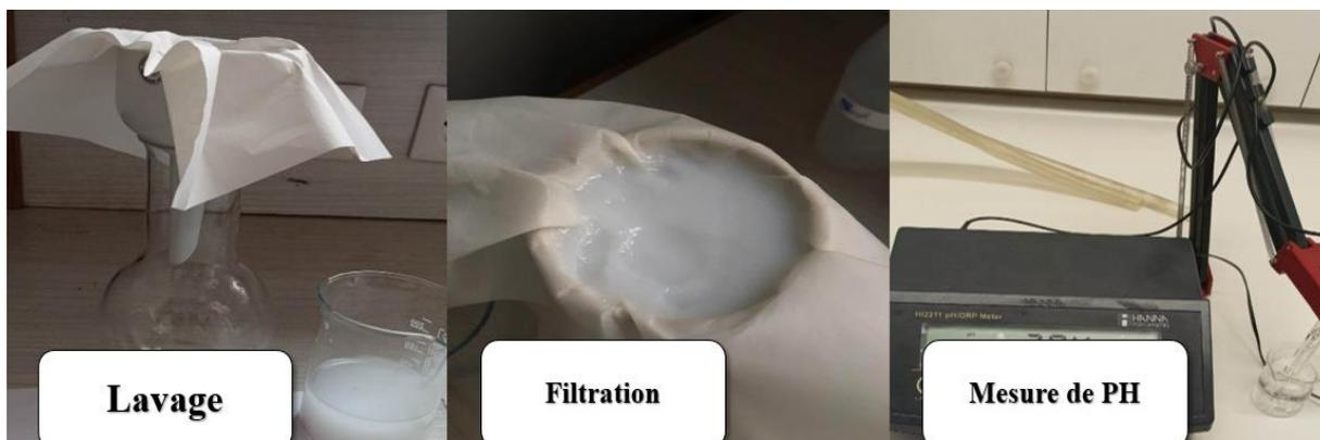
Figure II.16 : les étapes de lavage, filtration et mesure de PH.
