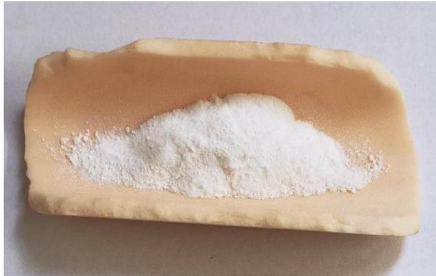
Figure II.5: Creuset en alumine
