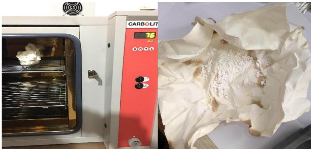
Figure II.17 : la poudre obtenue après 24h de séchage
