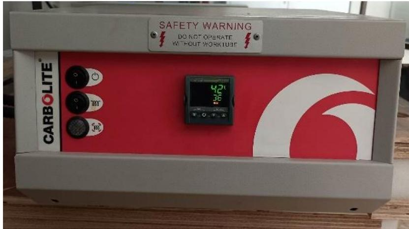
Figure II.7: Régulateur de la gamme Eurotherm 3216 PID de marque CARBOLITE
