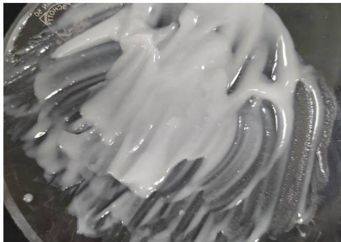
Figure (III.04) : photo illustrant l'aspect de la résine juste après refroidissement.
