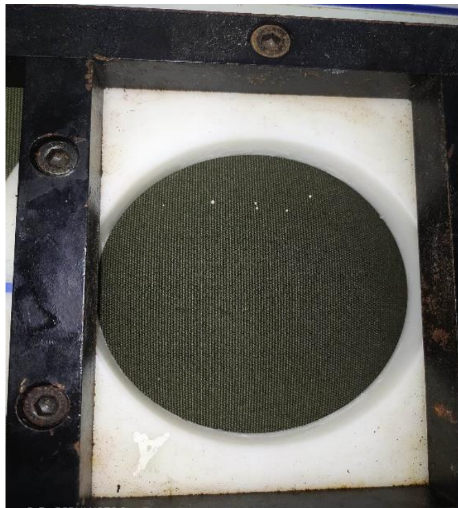
Figure II.5 : toile de bâche sous traitement.
