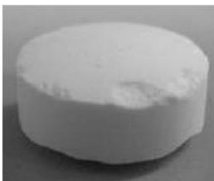
Figure I.6 Ebrèchement d'un comprimé
