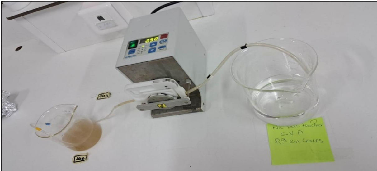
Figure 7: Photographie montrant dispositif expérimental illustrant la préparation des billes d'alginate / cellulose par extrusion.
