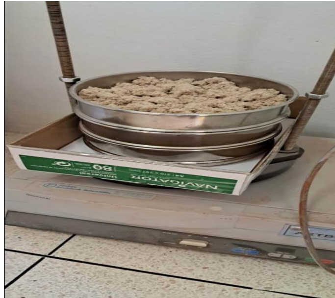
Figure 6: Photographie numérique montrant la tamiseuse utilisée (JINLING).
