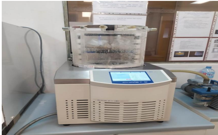
Figure 4: Photographie numérique montrant lyophilisateur (alpha 2-4 LSC plus).
