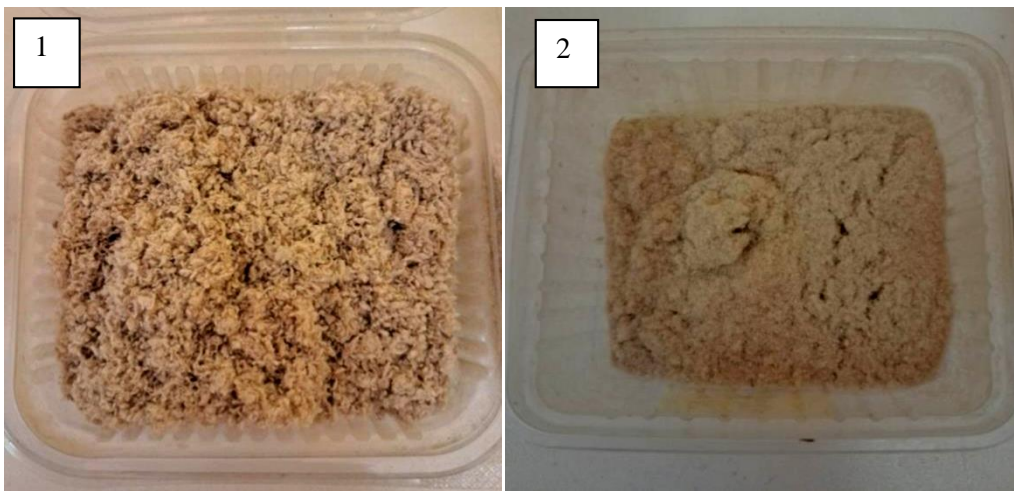
Figure 10: Photographies montrant les échantillons, 1: Après broyage, 2 : Après tamisage.
