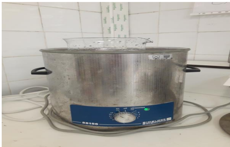
Figure 3: Photographie numérique montrant l'appareil d'ultrason (bioblock 88156) utilisée.
