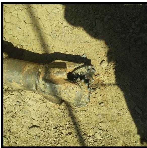
**Figure III.6 :** Outil utilisé pour le forage de reconnaissance.
