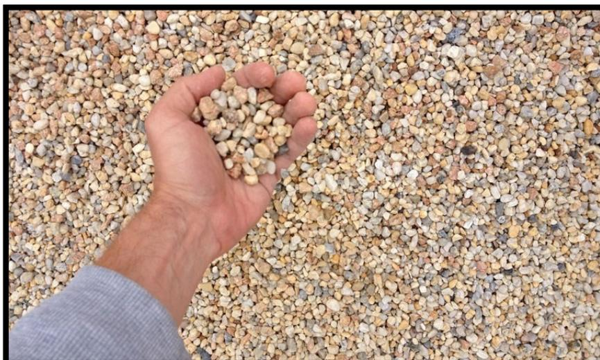
**Figure III.13** : Le massif filtrant.
