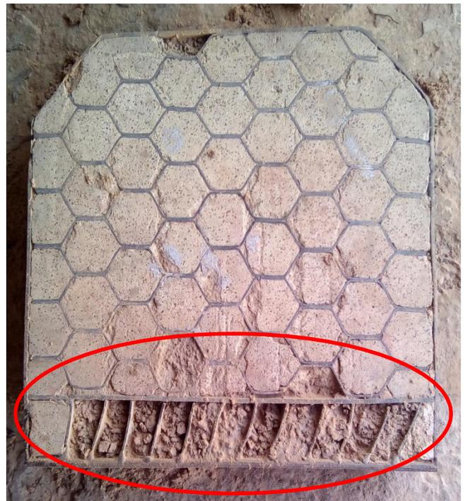
**Figure (18) Effet de l'augmentation de la pression sur le tiroir**
