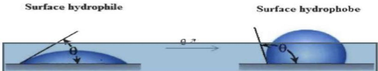
Figure II-7 : Caractérisation de la surface du matériau avec l'angle de contact.
