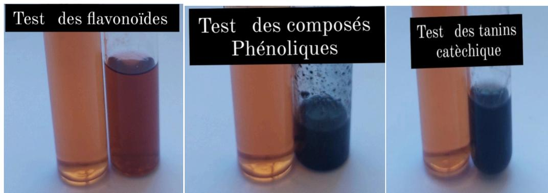
**Figure III-3 Résultats positifs de screening phytochimique pour la coquille et la membrane**
