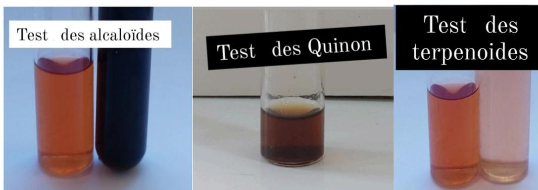
Figure III-4 Résultats négatives de screening phytochimique pour la coquille et la membrane
