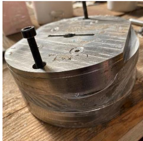
*Figure 3. 1moule de mise en forme des prothèses oculaires*
