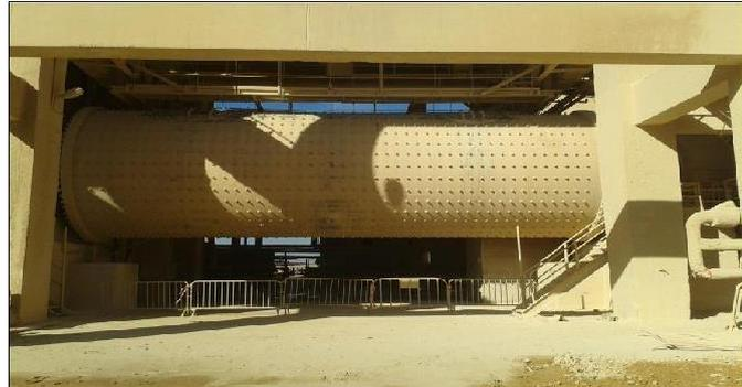
Figure.I.9 : broyeur cru.
