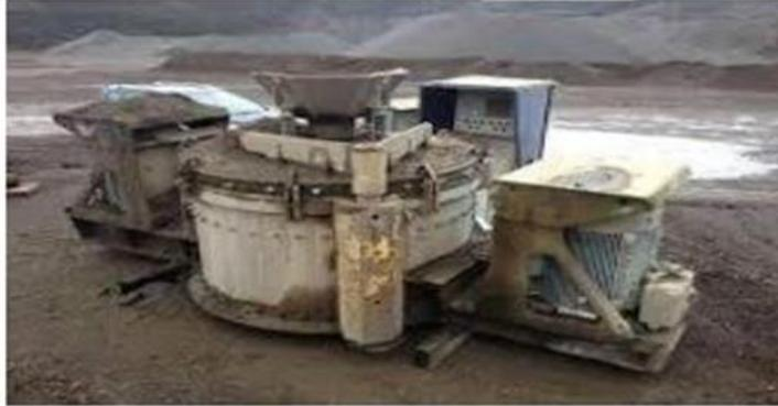
Figure II. 9. Concasseur à percussion à axe vertical. [7].
