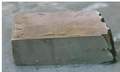
Figure IV.11. Forme d'échantillon obtenu après fraisage
