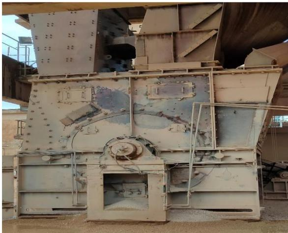
Figure IV.1. Photo réel du concasseur De cru KHD, PHM 3000\*3000
