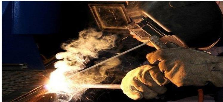
Figure II.7 : Photo real d'un soudage SMAW
