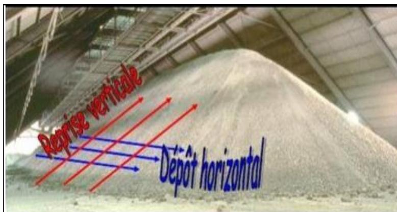
Figure.I.8 : Pré-homogénéisation du mélange calcaire-argile.
