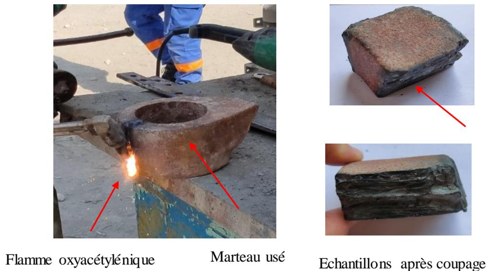
Figure IV.9. Coupage oxyacétylénique des échantillons
