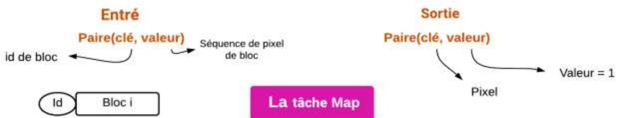
Figure 14:La phase Map de premier travail dans l'algorithme Huffman en Hadoop
