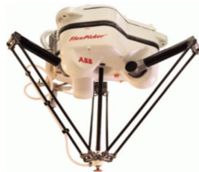
Figure 5:Bras manipulateur parallèle [4].
