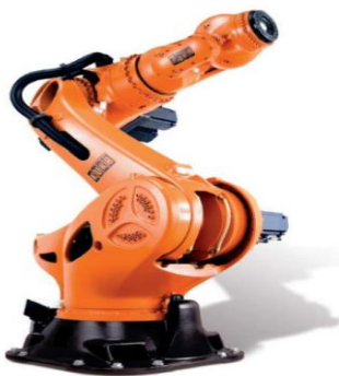
Figure 4:Bras manipulateur série [4].
