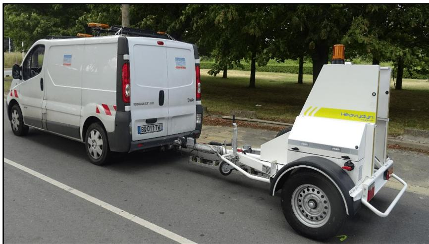
Figure I.17 : Les déflectomètres pour contrôle [02]
