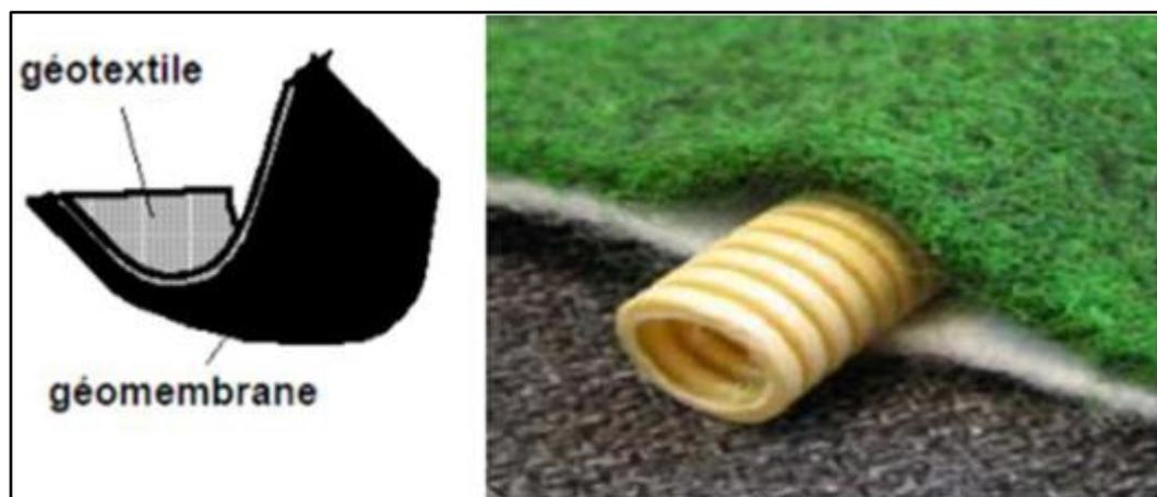
Figure II.12 : La structure d'un géo-composite [12]
