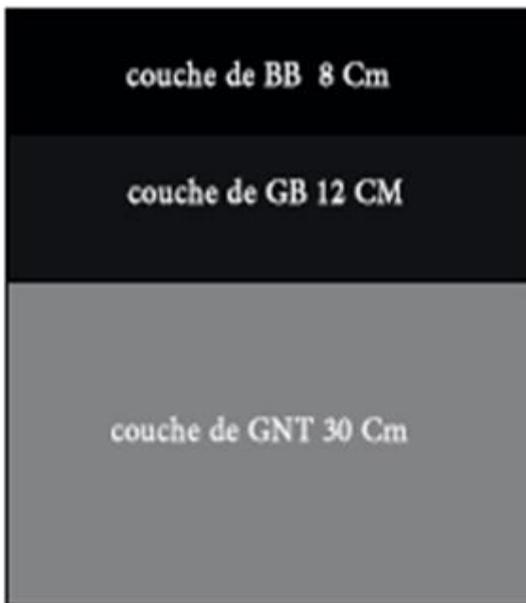
Figure IV.2 Structure de la chaussée RN36
