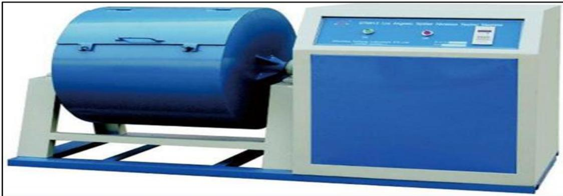
Figure III .8: l'essai los Angeles
