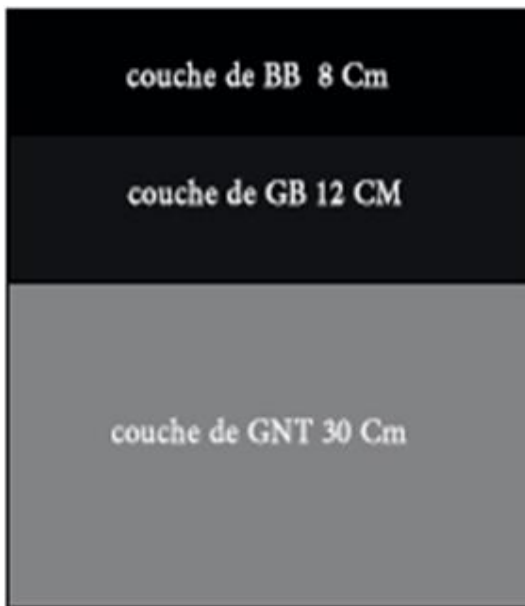
Figure IV.2 Structure de la chaussée RN36
