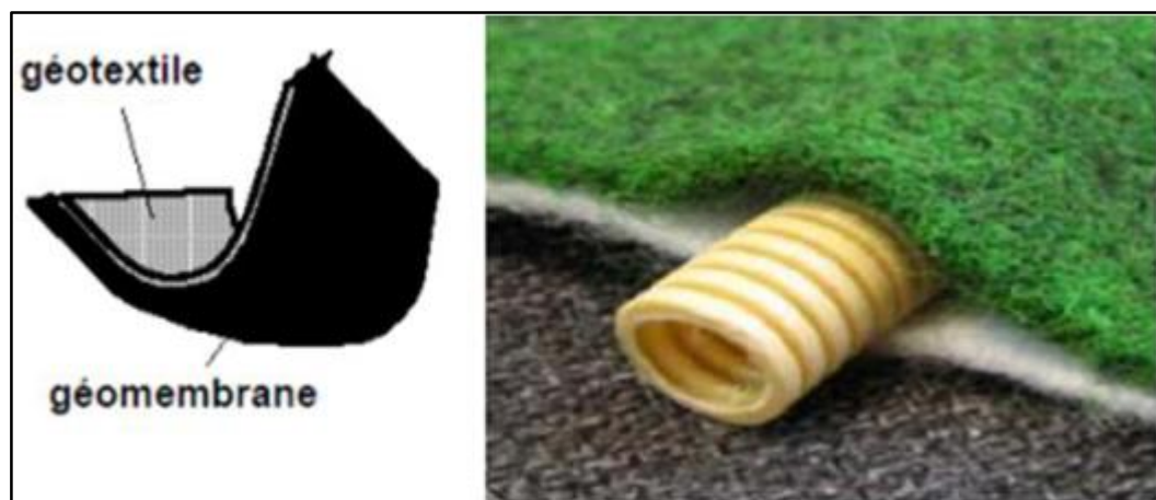
Figure II.12 : La structure d'un géo-composite [12]
