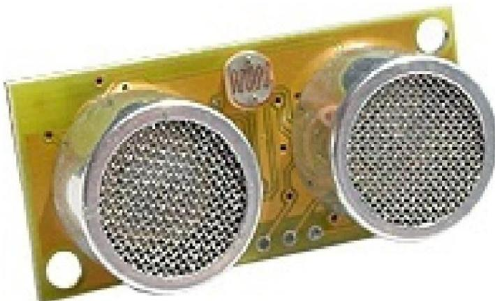
Figure2.6 Télémètres ultrasonores.
