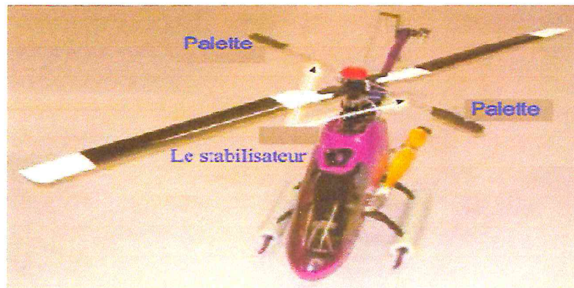
Figure (I.20): Le stabilisateur à inertie
