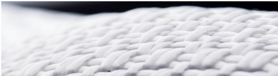
**Figure I.42 :** Exemple du géotextile tricoté
