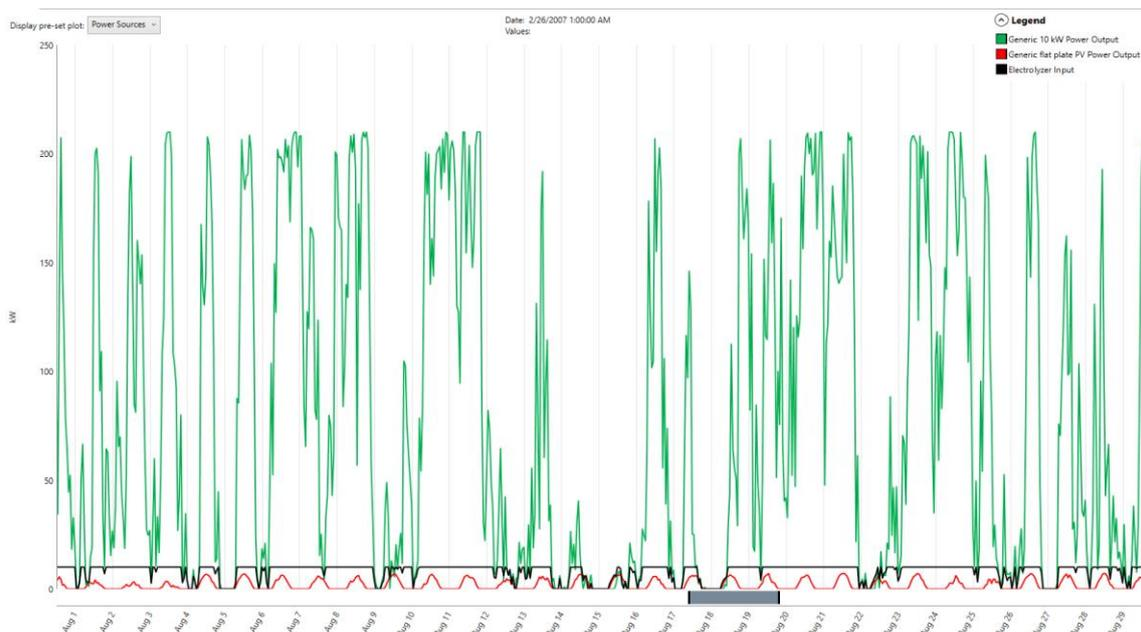
Figure 3.32: Comparaison entre l'énergie éolienne et photovoltaïque produite et celle consommée par l'électrolyseur pour le mois d'aout
