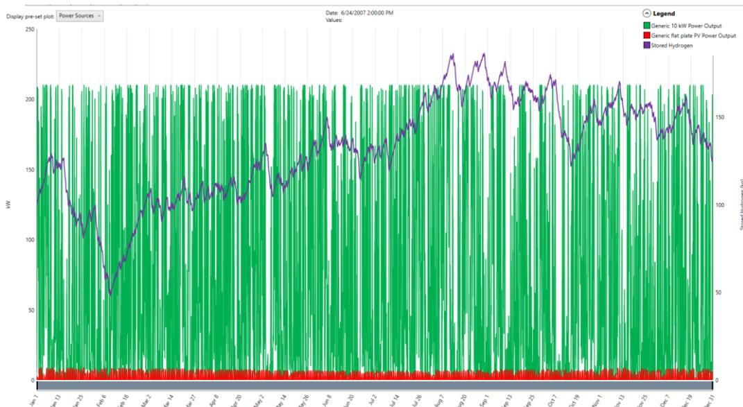
Figure 3.30: Evolution du stockage de l'hydrogène en fonction de la production du générateur photovoltaïque et l'aérogénérateur
