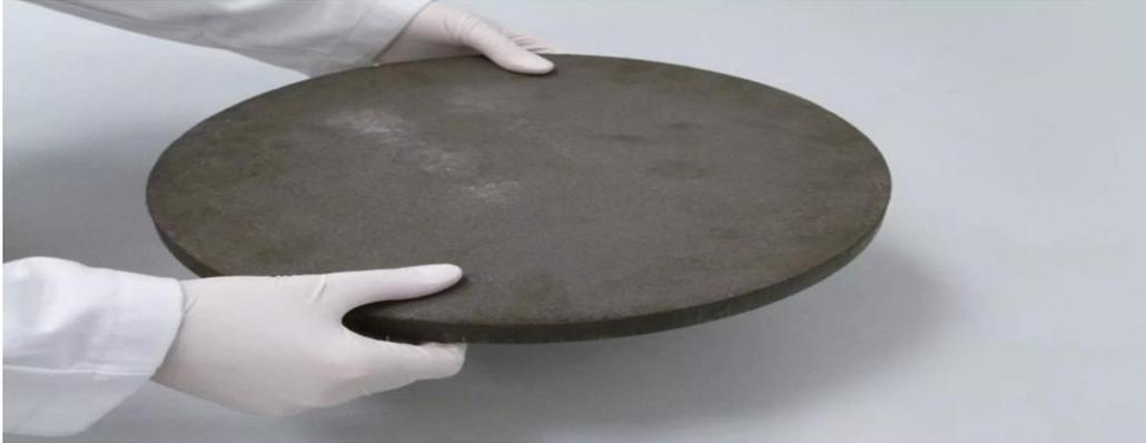
Figure 2.13 : Galette solide formée d'hydrogène et de métal.[62]
