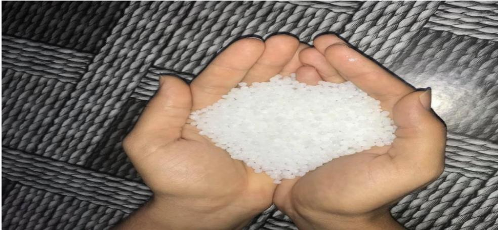
**Figure 1.7** Granules de thermoplastique du type PEHD
