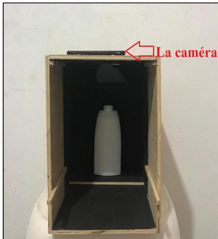
**Figure 3.6** Fixation de la caméra et la bouteille
