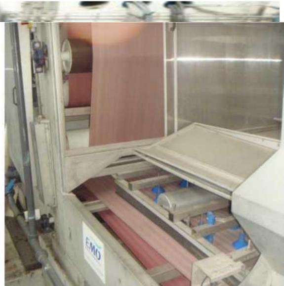
**Figure V.20 : Les filtres à bande**
