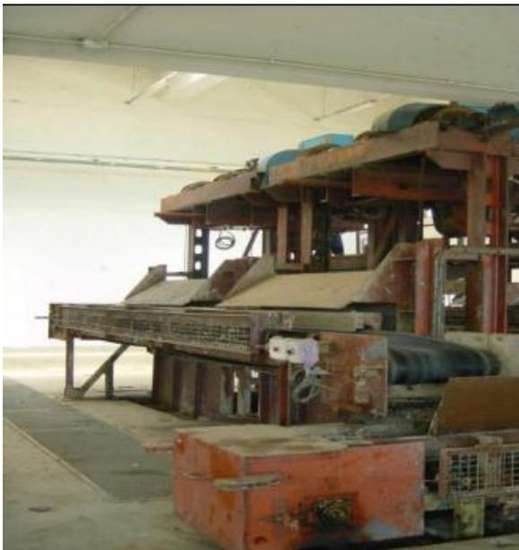
**Figure IV.20 : Poste de dégrillageBandes (Transporteuses d'évacuation des refus)**
