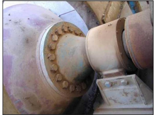
**Figure IV.17 : Etat des raccords entre la vis et le Moto-réducteurs**
