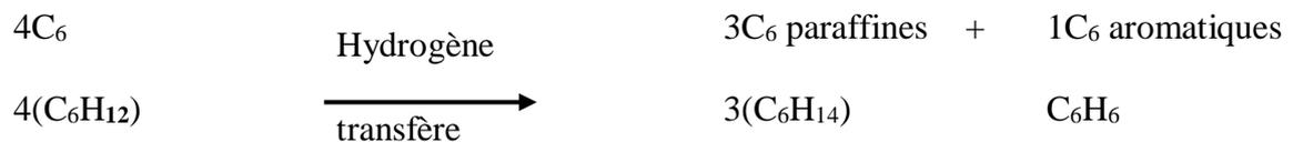
Ça implique quatre oléfines en C<sub>6</sub> converties en trois paraffines par gain d'hydrogène et une aromatique par perte d'hydrogène. Cette réaction est extrêmement importante pour les résultats d'ensemble du craquage, car elle a deux conséquences principales :
