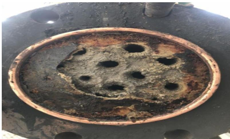
**Figure III.7 :** problème d'encrassement d'échangeur E02
