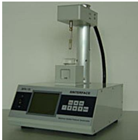
Figure 11 : Mesure de la TS à l'aide d'un tensiomètre
