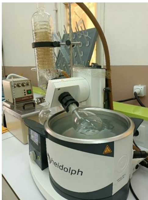
Figure 15 : Dispositif de concentration du biosurfactant (Rotavap)
