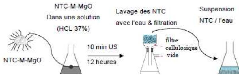
**Figure 2 : Principe de l'extraction des NTC par HCl et lavage.**
