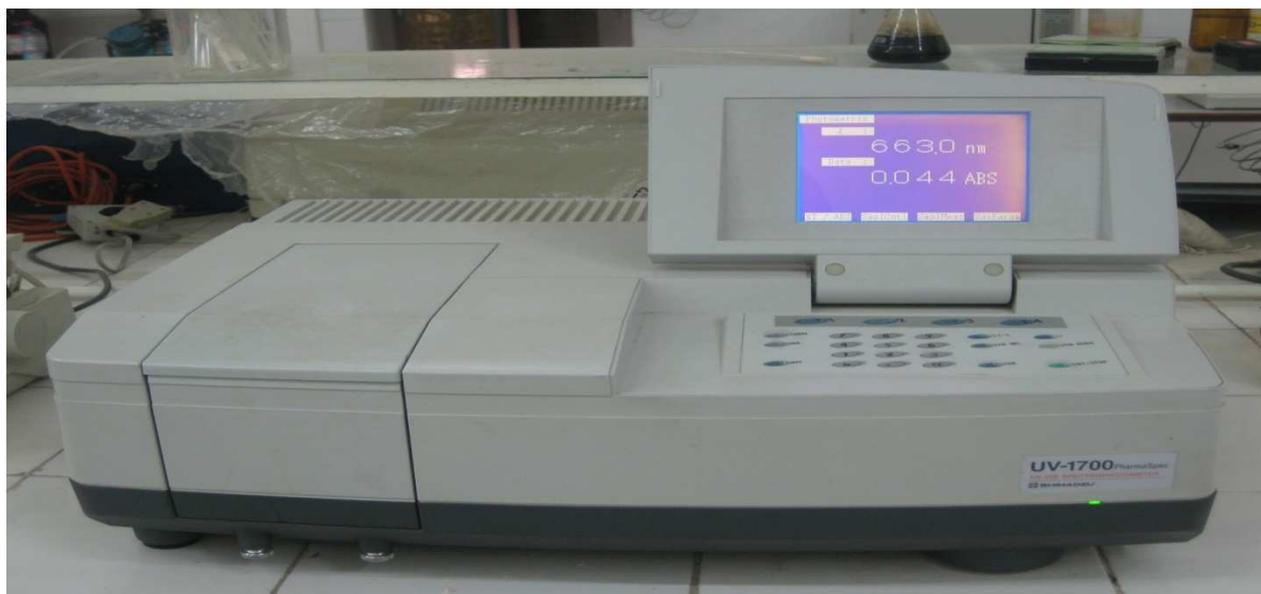
**Figure IV.2 : Schéma représentatif d'un spectrophotomètre UV-Visible de type SHIMADZU-1700.**
