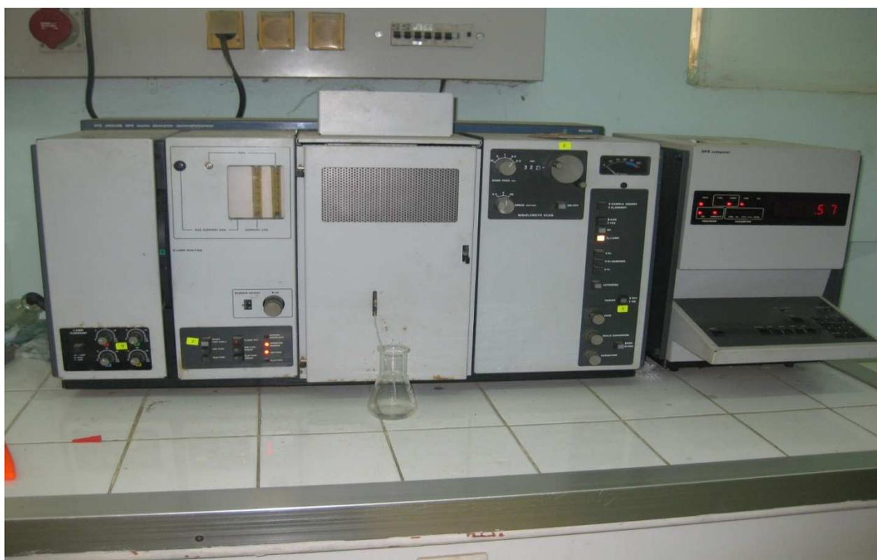
**Figure IV.1 : Schéma représentatif de l'absorption atomique, PYE UNICAM SP9**
