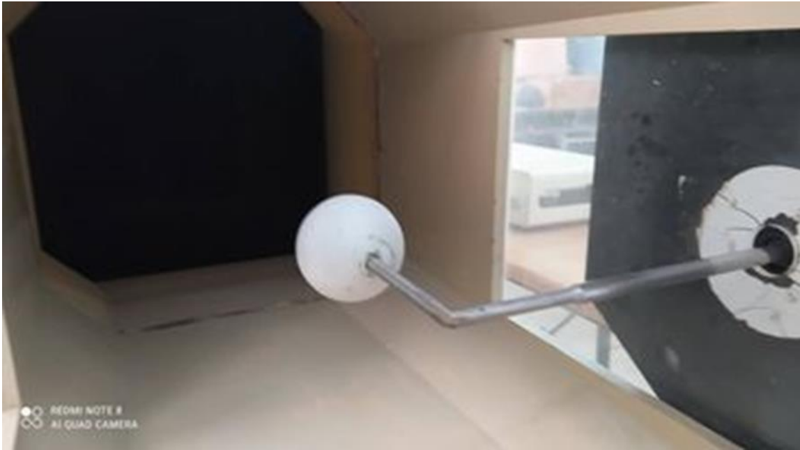
Figure III.10: la sphère dans le souffleur
