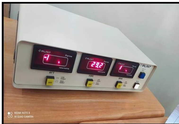
Figure III.3 : Et c'est ainsi qu'on peut mesurer la force de traînée sur le modèle.
