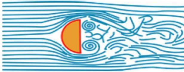
Figure. I.14 : Résistance de demi sphère 75 %.
