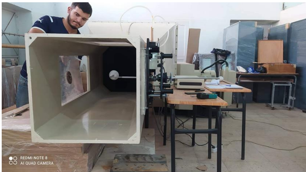
Figure III. 7 : installation de premier modèle dans la soufflerie
