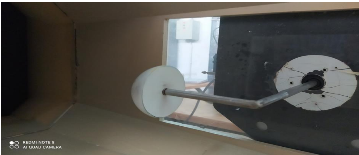
Figure III.11 : demi-sphère dans le souffleur
