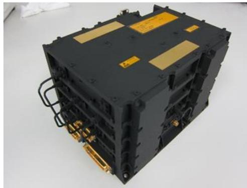
Figure 1-14: Transpondeur Spatiale en bande Ka
