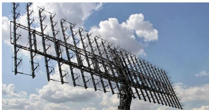
Figure 1-13: Une Antenne Matricielle.
