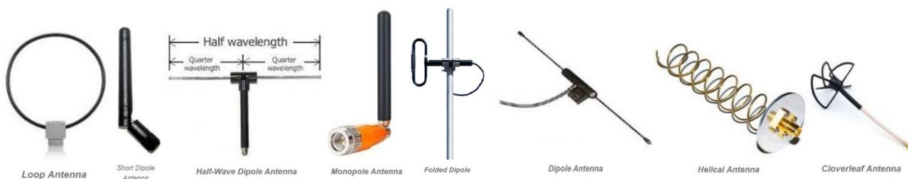
Figure 1-7: Les différents types des antennes filaires.
