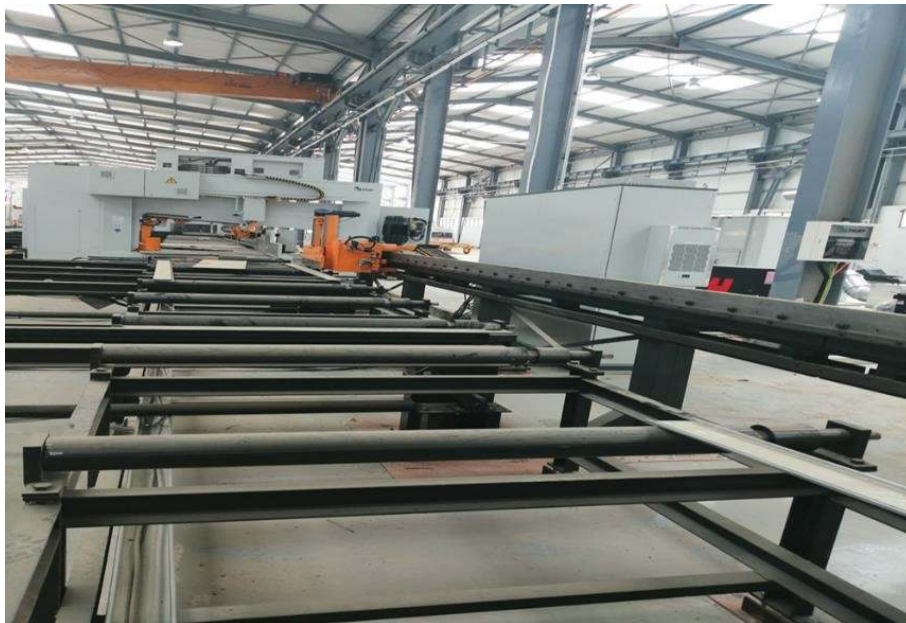
Figure 12 : Machine sciage de profilé : Scie à ruban.
