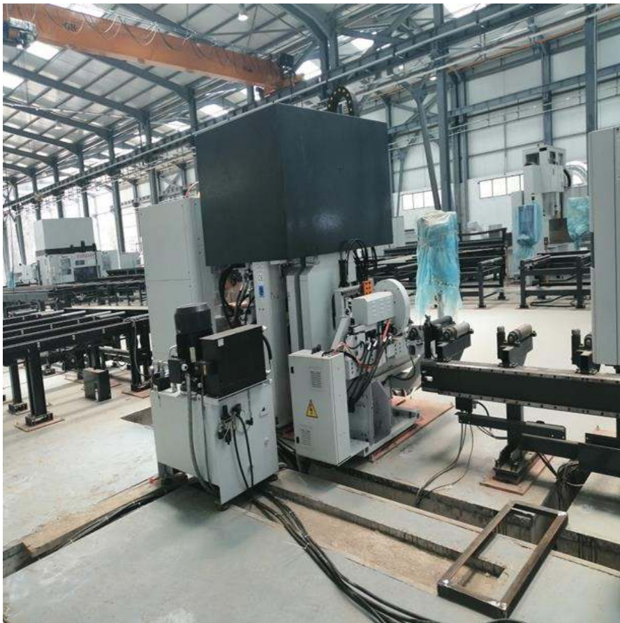
Figure 13 : Machine de poinçonnage/ Débitage pour les petits profilés.
