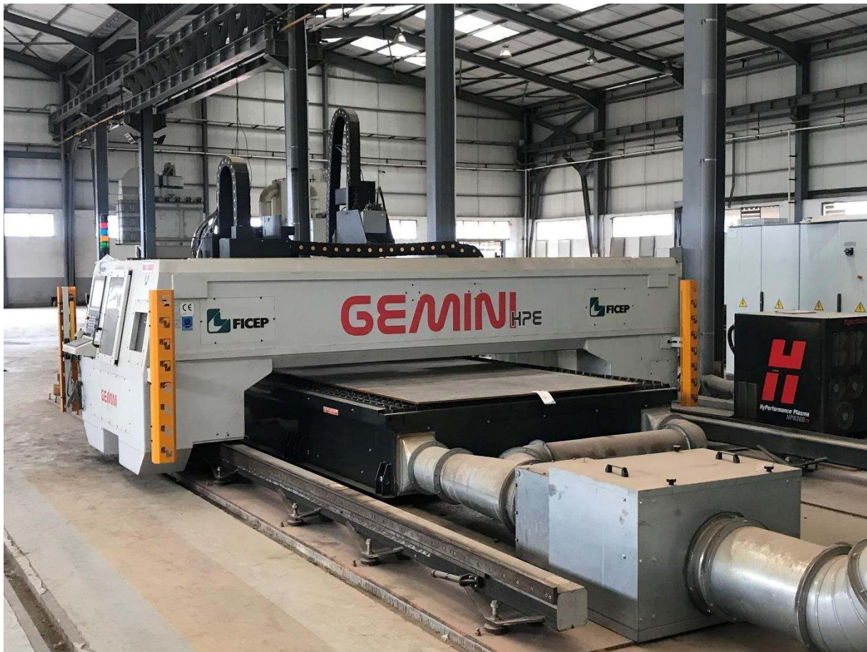
Figure 17 : Coupe et perçage tôle grugeage.
