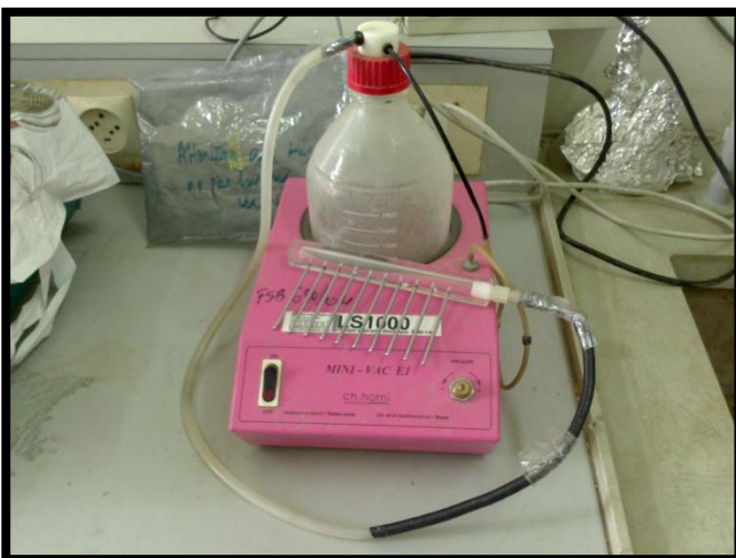
Pompe aspirante électrique de marque MINI-VAC LS1000
