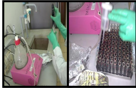
1 er Lavage des tubes par la solution de lavage
