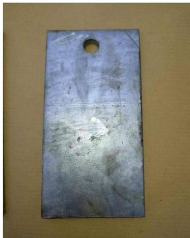
**Figure III 3.**Plaque polie avec papier émeri de 80 / 220 et galvanisée durant une minute.
