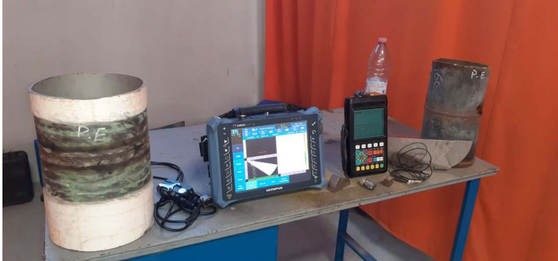
Figure III.4 : Préparation du contrôle par ultrasons
