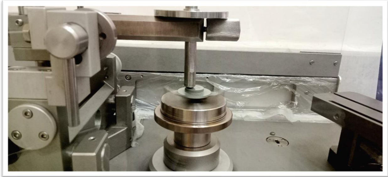
Figure 5. 8 Fonctionnement du tribomètre pion sur disque.
