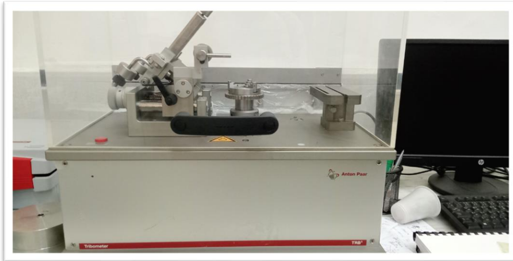
Figure 5. 6 Tribomètre de type CSM Tribometer, Switzerland, Anton Paar TRB3
