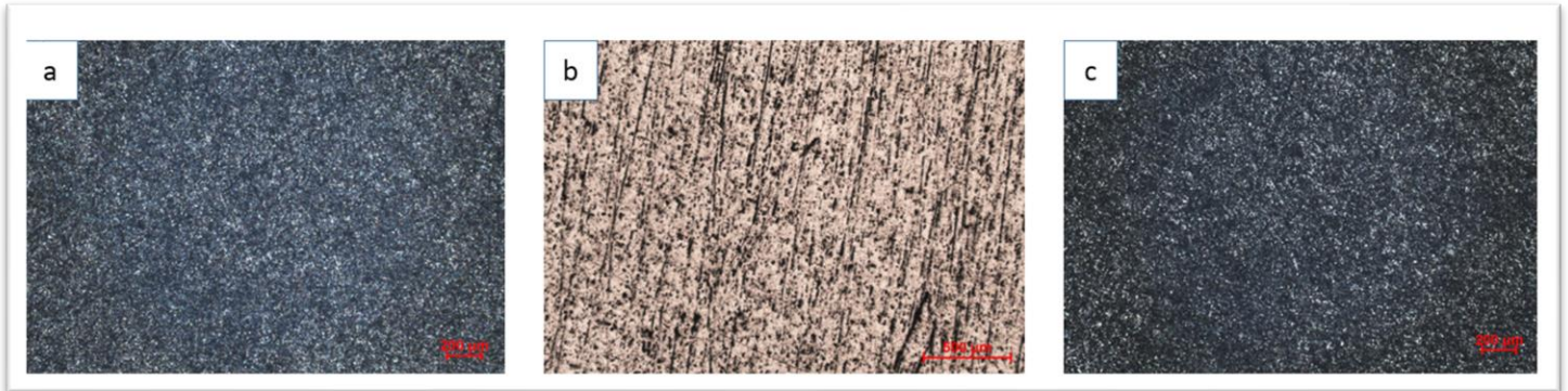
Figure 5. 9 Microstructures à l'échelle de 25µm des différentes température de frittage (a) 500°C (b) 550°C (c) 600°C
